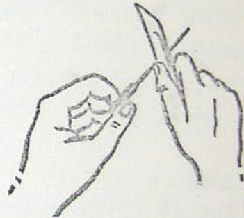
2. Jedním odizolovaným koncem drátu (vodiče) spoj vývody A a F na dynamu podle vyobrazení.
