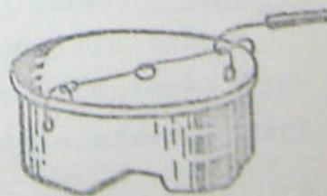
4. Kouskem izolovaného drátku omotej kousek dřeva. Tento drátek ve vhodné vzdálenosti odizoluj (viz obrázek) tak, aby dříve než se plovoucí dřevo dostane až na dno plechovky, došlo ke spojení obou odizolovaných částí. Proveď drátek očkem druhého drátu - odizolovaná část od dřeva musí být až nad očkem.
