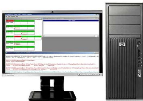
Obr. č. 13: Terminál řízení sítě NMT-Network Management Terminal
